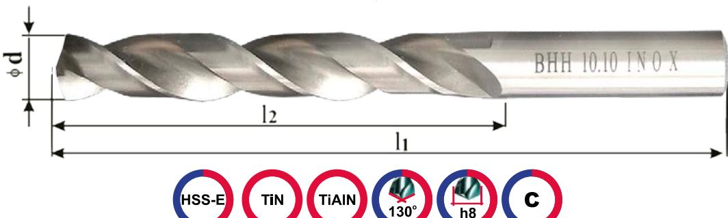
Wiertła kręte prawotworne z chwytem cylindrycznym do stali nierdzewnych wykonane metodą szlifowania z korekcją ściną typu „C”.
